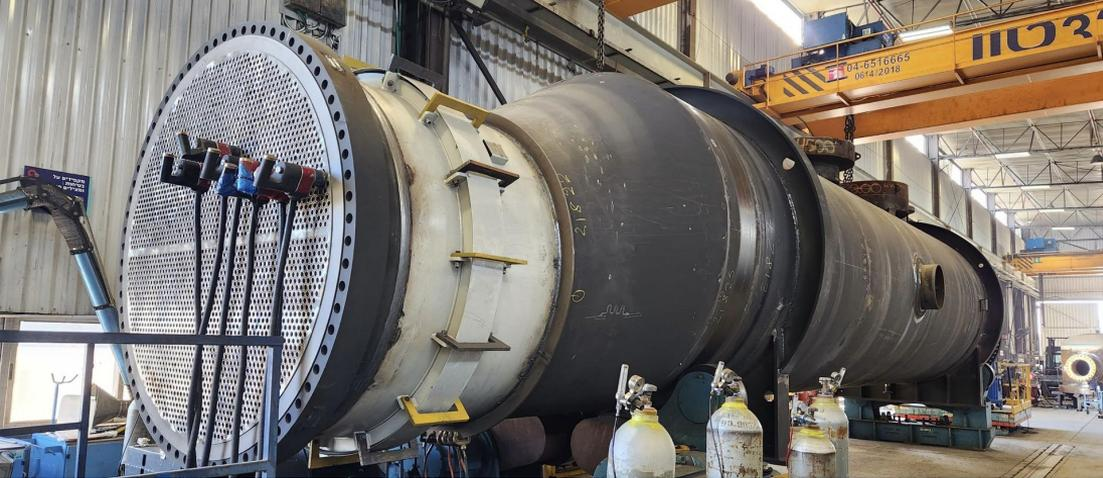
VAPORIZER HEAT EXCHANGERS BEING READIED FOR FACTORY HYDRO TESTING
